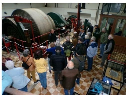
Machine d'enroulement des câbles pour la cage et les bennes
